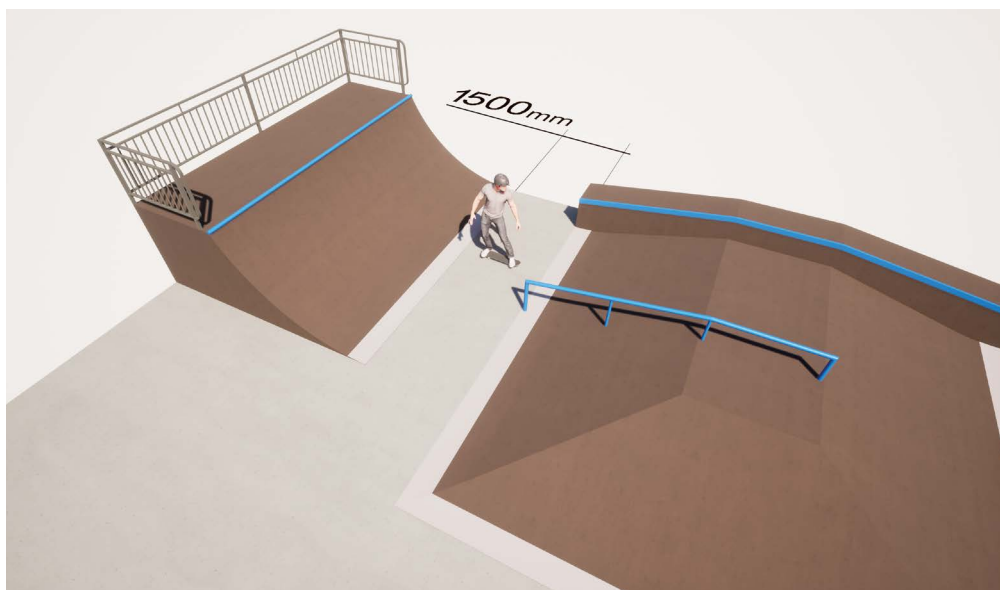
Ошибка в выборе расстояния при установке фан-бокса и разгонной горки
